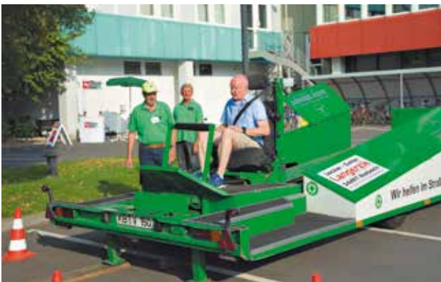
Ralf Göltzer testet im Gurtschlitten die Kräfte eines Autoaufpralls. Mit diesem Simulator wird nicht nur die Bedeutung von Anschnallgurten, sondern auch die richtige Gurtposition demonstriert. Foto: Karin Tilch
