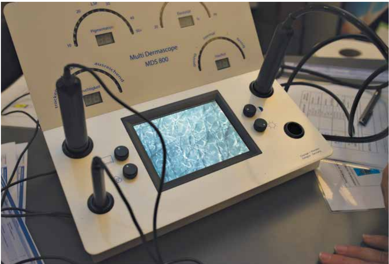
Analyse der Hautstruktur der Hand mittels Hautkamera. Auf dem Display ist die Haut in Großaufnahme zu sehen. Foto: Karin Tilch
